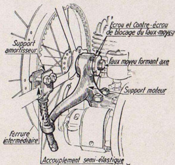
4° Mettre la roue arrière en place. S'assurer que la couronne dentée ne frotte pas sur la fourche; sinon, introduire une rondelle intermédiaire sur l'axe du moyeu, pour augmenter l'écartement de la fourche. Monter le faux moyeu à la place de l'écrou de blocage du moyeu. Régler le jeu latéral (libre sans jeu) par blocage du contre écrou sur l'écrou à encoches.
