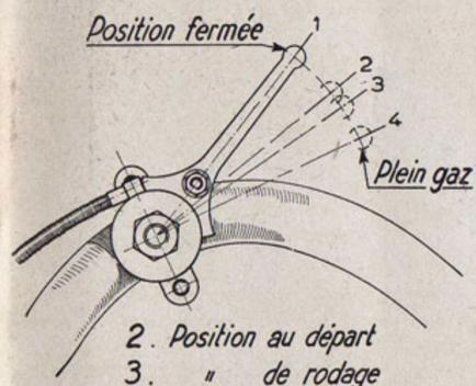
Ne jamais rouler longtemps le volet complètement fermé, l'excès d'essence risquant de gripper le moteur.
