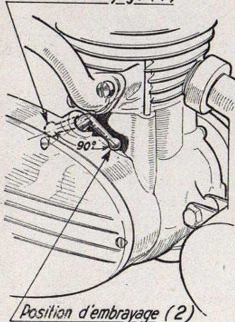
Pour cela, mettre le levier placé à la partie supérieure du carter dans sa position (2) indiquée par le schéma ci-contre.
