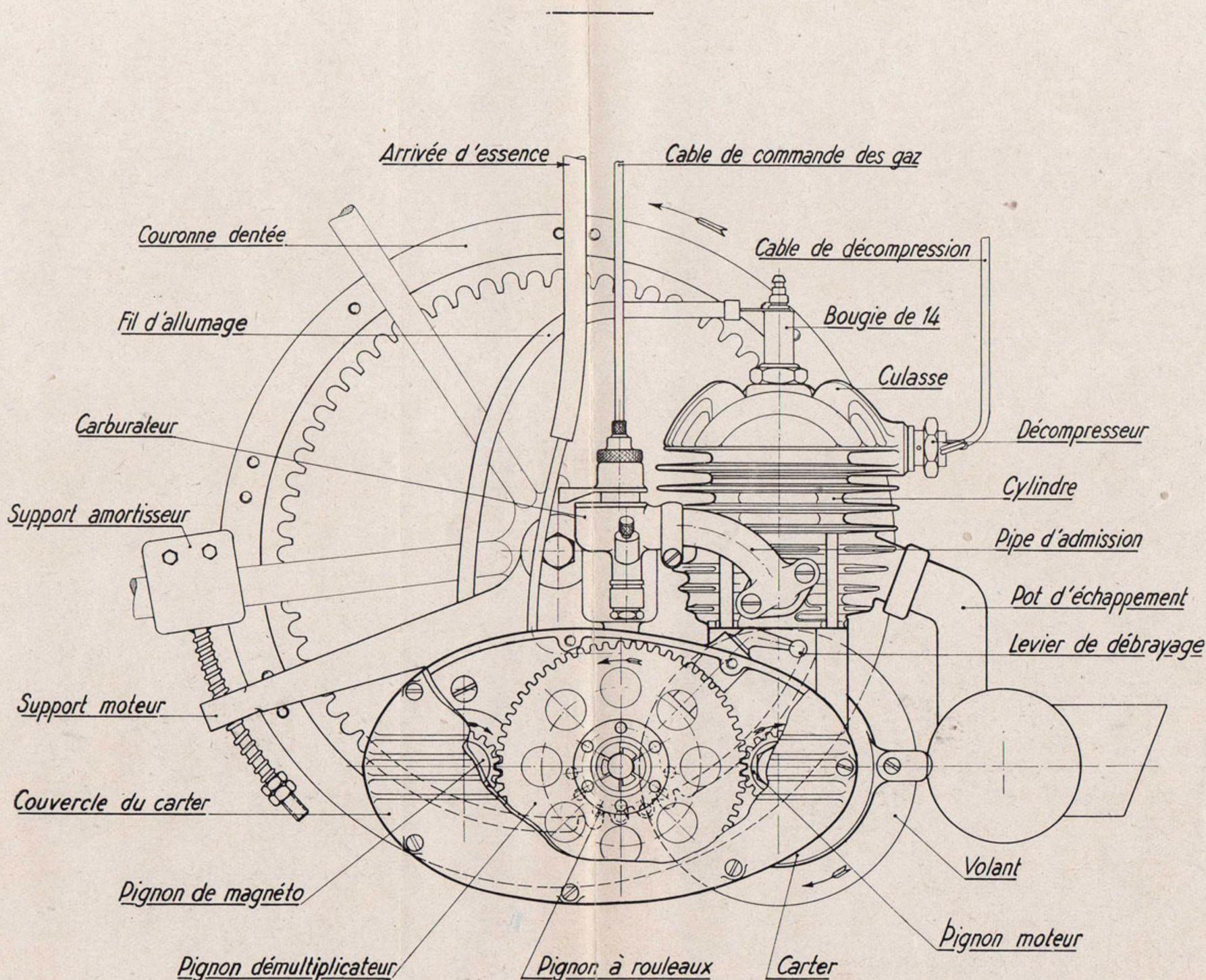
Villebrequin en 2 parties : l'une portant le volant, l'autre le pignon-moteur, en acier forgé, tournant sur roulements à billes.
