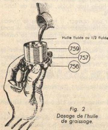
ajoutée au carburant) une huile de faible viscosité (comprise entre les viscosités de S.A.E. 20 et S.A.E. 30), c'est-à-dire une huile fluide (genre MOBILIL ARCTIC ou A, ou CASTROL CV).
