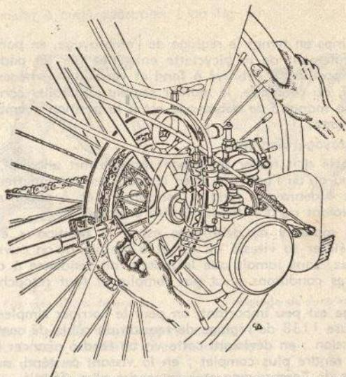
L'intervalle entre la pointe et le fond des dents ne doit pas varier de plus de 0,5 m/m. en plus ou en moins quand le centrage est correct.
