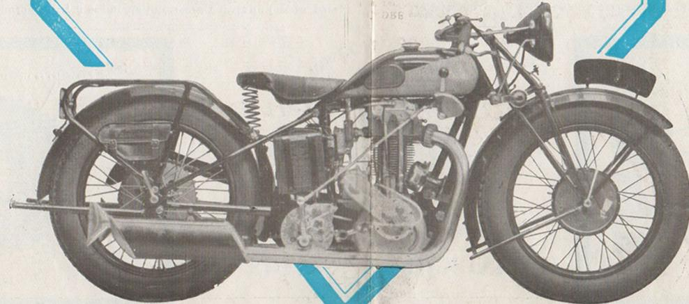
Les 350 et 500 c/m<sup>3</sup>, SUPERSPORT avec éclairage électrique Ducellier. types G et H, à culbuteurs
