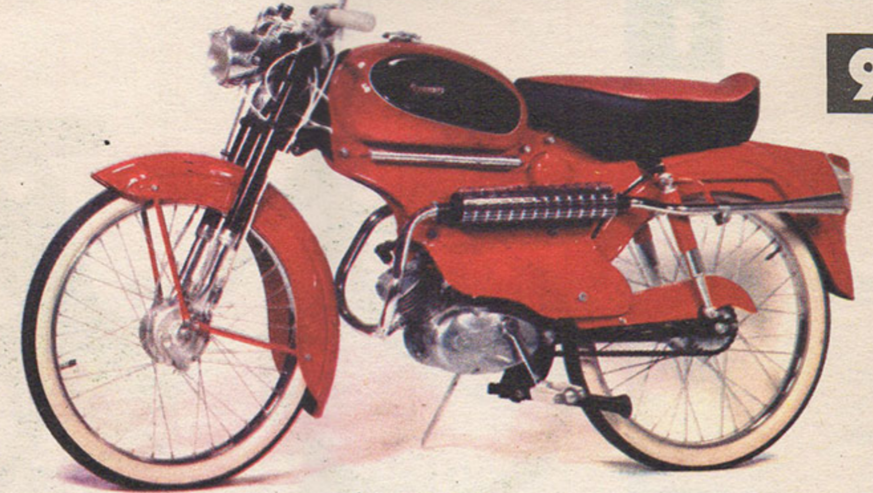
N° 225 - Identique au 222. mais avec moteur 48 cm 3 2 temps 2 vitesses à pédalier incorporé. N° 230 - Même modèle, mais avec moteur 48 cm 3 2 temps 3 vitesses, à pédalier incorporé. Supplément aux 222 - 225 - 230 . Porte-bagages coulissant avec porte-sacoche.
