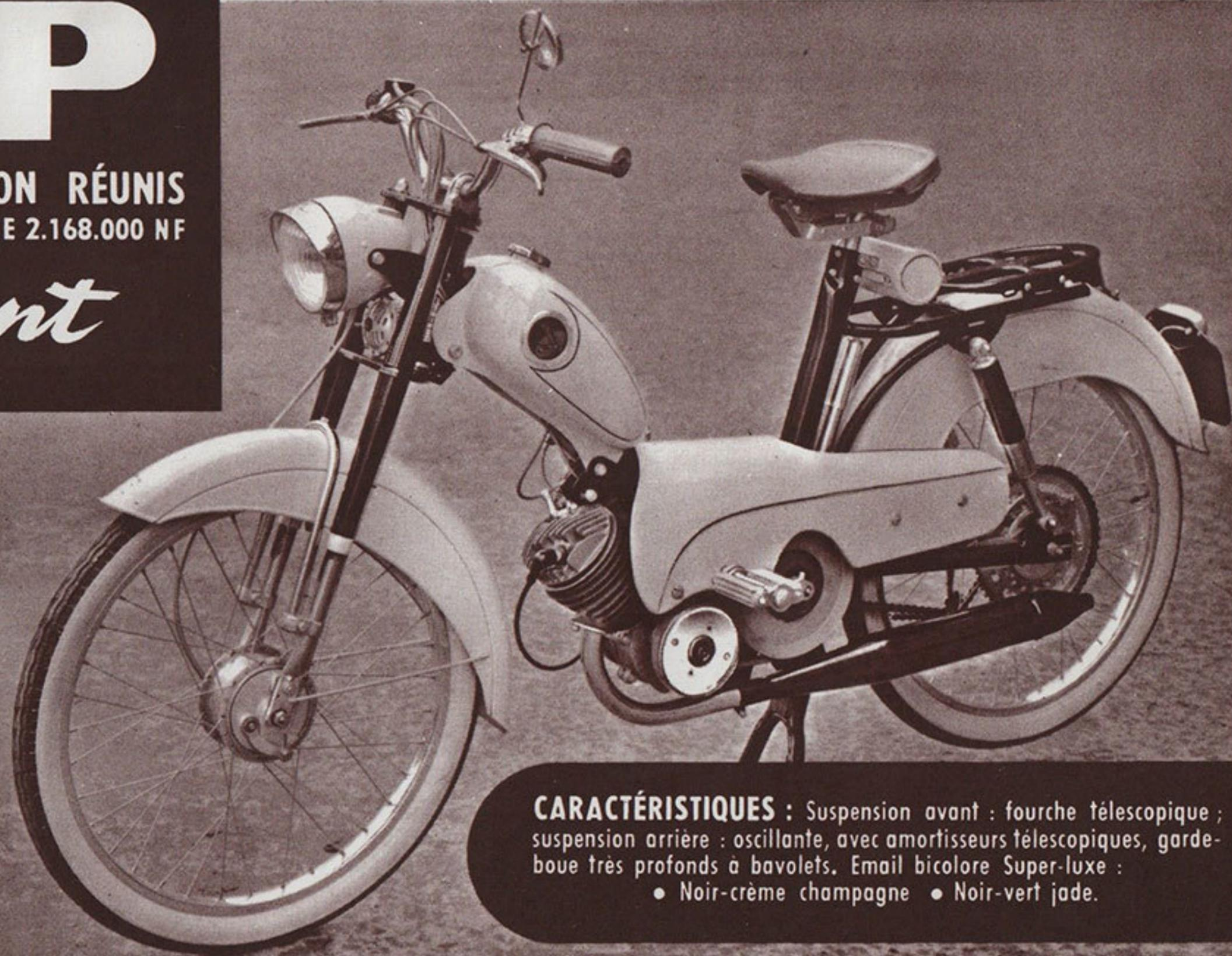
**CARACTÉRISTIQUES** : Suspension avant : fourche télescopique ; suspension arrière : oscillante, avec amortisseurs télescopiques, garde-boue très profonds à bavolets. Email bicolore Super-luxe :
