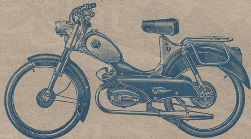
DS. 81 — Moteur VAP Pi Bloc 2 vitesses, manivelles Kick - 1 seule chaîne - Frein AR au pied par manivelles rétropédalage.
