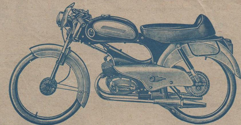
M. 81 — Moteur VAP Pi Bloc 2 vitesses, manivelles kick - 1 seule chaîne - Frein AR commandé au guidon ou par manivelles rétropédalage. Egalement avec frein AR au pied indépendant des manivelles en supplément (recommandé).
