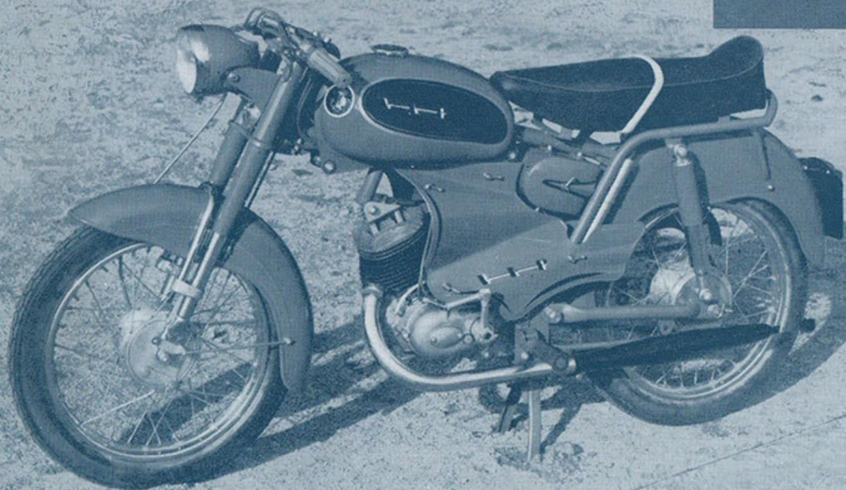
**CARACTÉRISTIQUES :** Cadre allongé surbaissé et renforcé - suspension AR oscillante renforcée - moteur VAP 3 vitesses 110 cm<sup>3</sup> - réservoir spécial "ITALIEN" de 9 litres - fourche télescopique renforcée - guidon grand sport "ITALIEN" jantes WESTWOOD MOTO - pneus motos de 2,75 x 16 - phare avec compteur incorporé - avertisseur électrique - selle biplace - carénage avec boîte à outillage incorporée.
