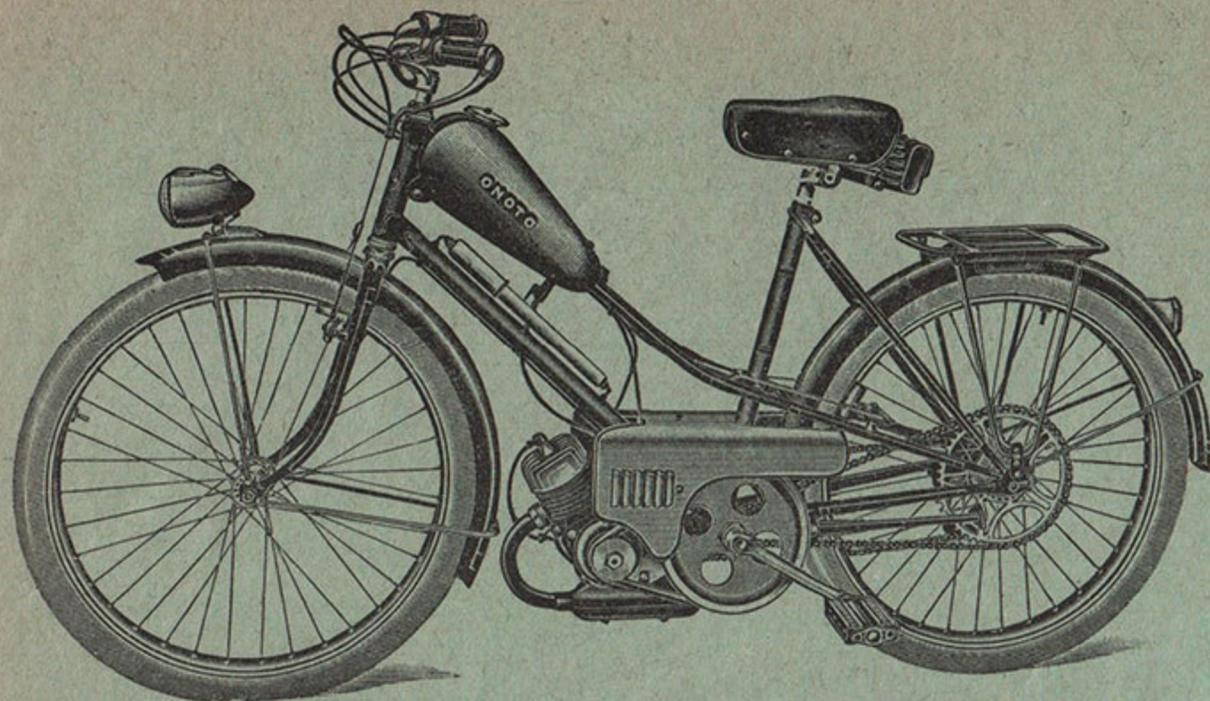
Moteur " MISTRAL " monovitesse type 54 (48 cm<sup>3</sup>); moyeu tambour arrière, grand diamètre; embrayage à cône très progressif; vitesse 35 km/h; fourche ordinaire ou télescopique sur demande.
