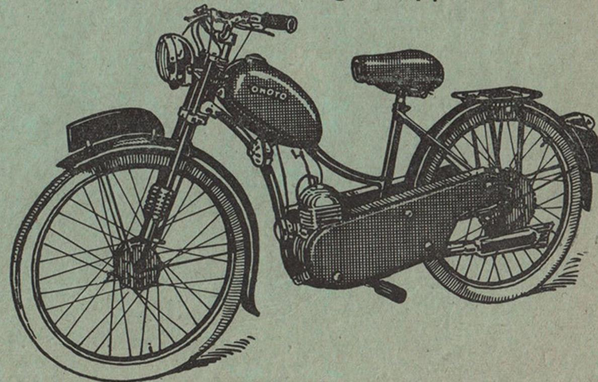
Moteur " LAVALETTE " 70,5 cm<sup>3</sup>; trois vitesses; mise en route par kick; roues et pneus de 600 x 55 C; fourche télescopique; deux freins tambour grand diamètre; vitesse 70 km/h. Ce modèle peut être livré avec cadre homme (genre moto).
