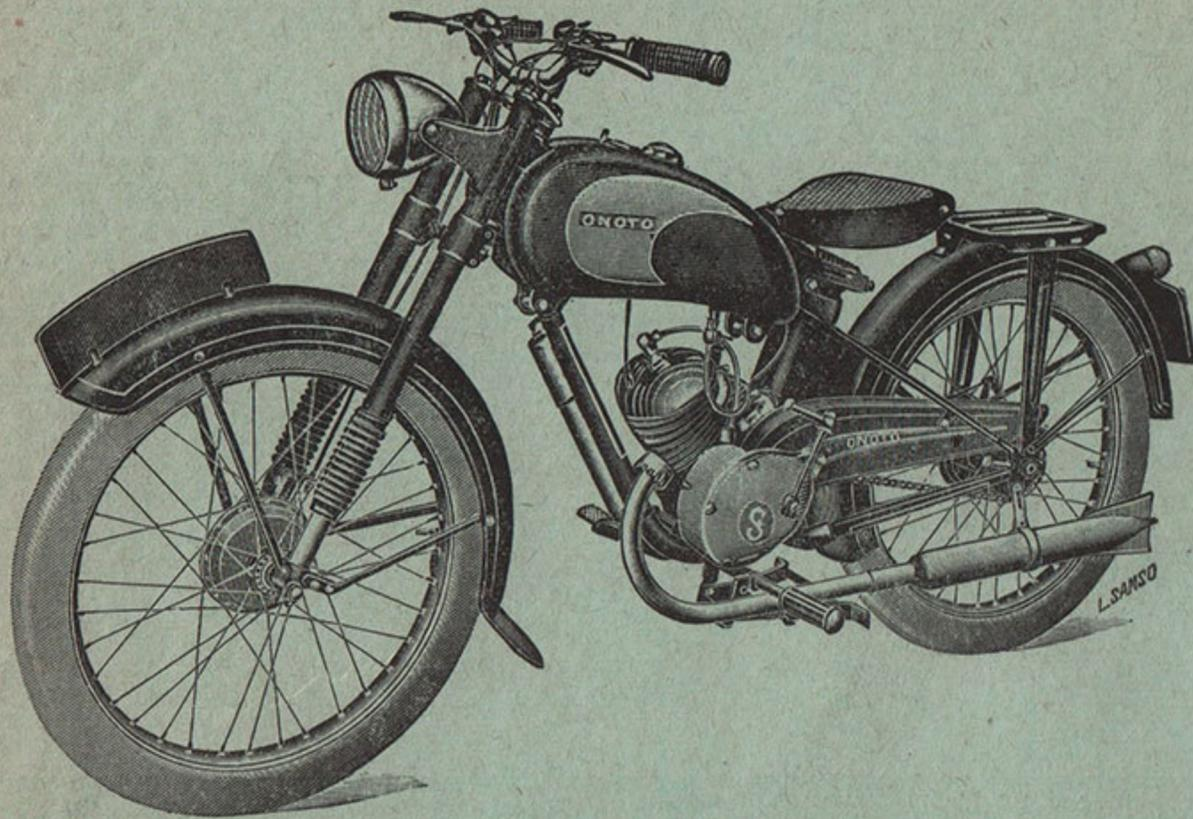
Bloc-moteur " SACHS " 98 cm<sup>3</sup>; fourche télescopique; roues de 600 × 65; réservoir 12 litres; deux freins tambour.
