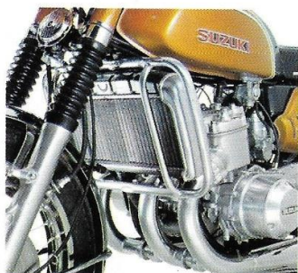
Refroidissement à eau, 3 cylindres
