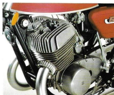
Moteur à deux cylindres, confirmé en course
