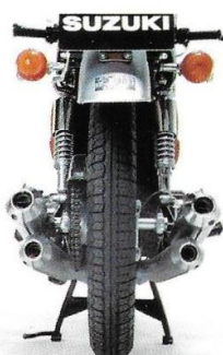
3 cylindres, 4 pots d'échappement
