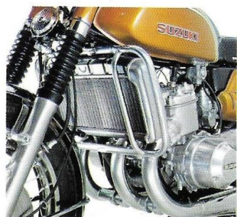
Refroidissement à eau, 3 cylindres
