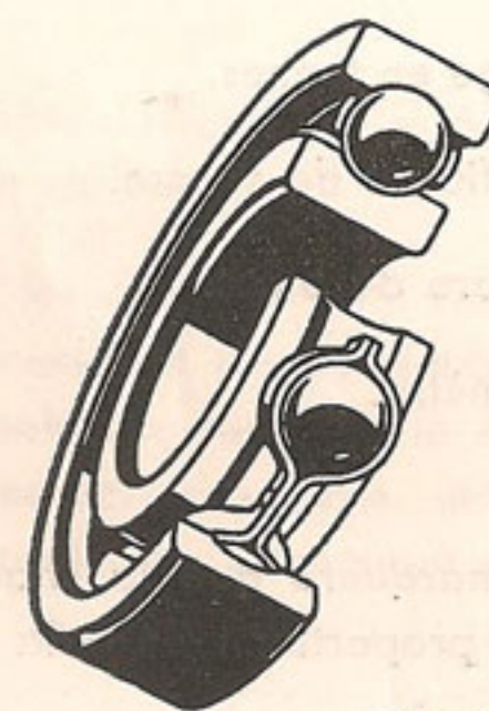
Fig. 2 : LE ROULEMENT A BILLES EMPRISONNEES DANS UNE CAGE, EVITANT LE CONTACT ENTRE ELLES.
