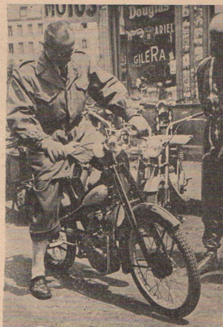
La mise en marche se fait au point fixe, la pédale servant de kick.
