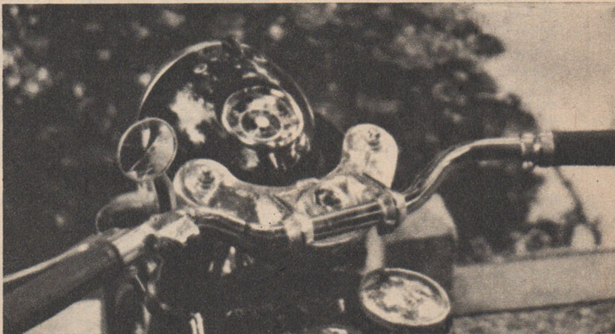
Le phare comporte le compteur, le contact et l'indicateur lumineux de point-mort.
