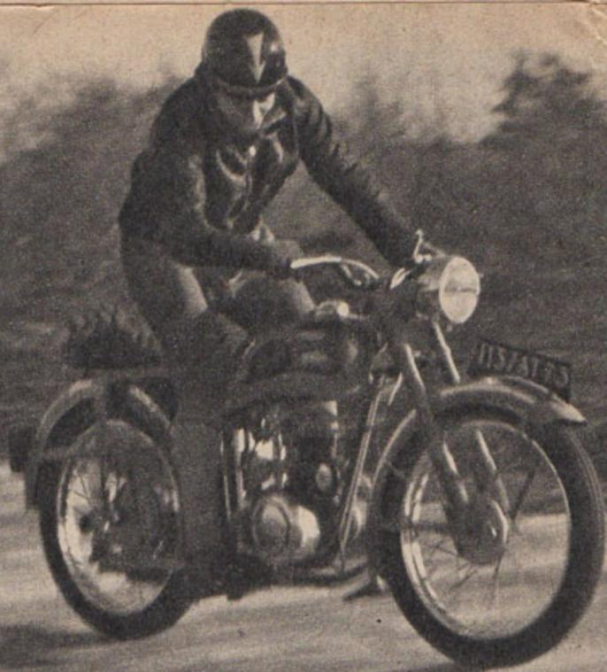
*Essai sur un raccord en « lôle ondulée ». Là encore, parfaite adhérence des roues, bien que l'essayeur tente de décoller la roue AV. en tirant sur le guidon.*
