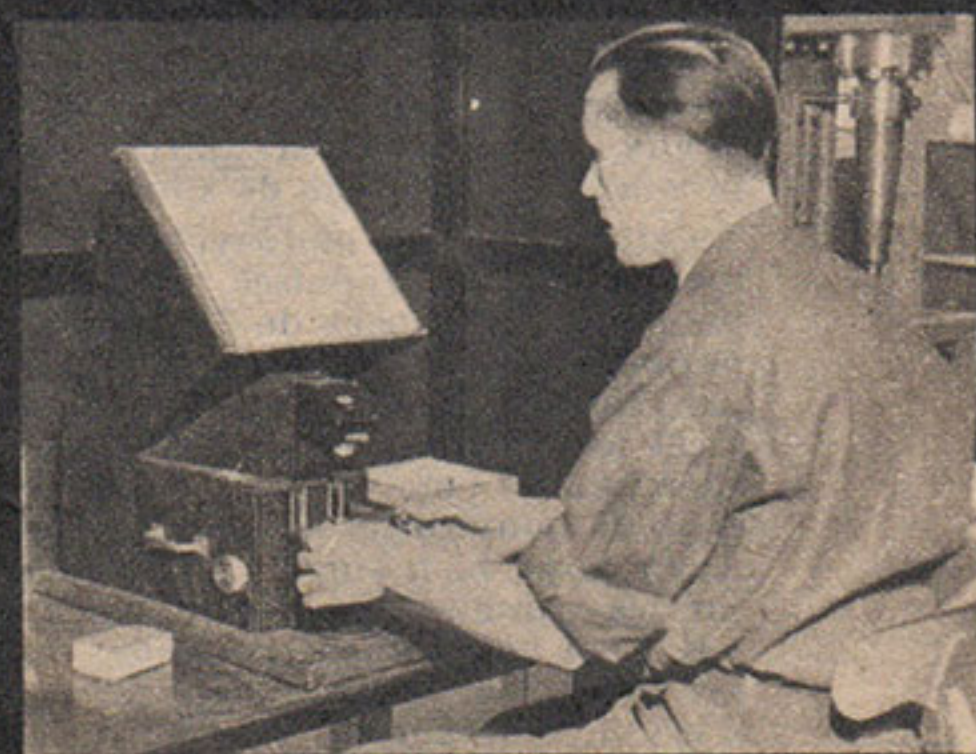
Instrument micrométrique de mesure par réfraction. — A gauche, l'écran de l'appareil.
