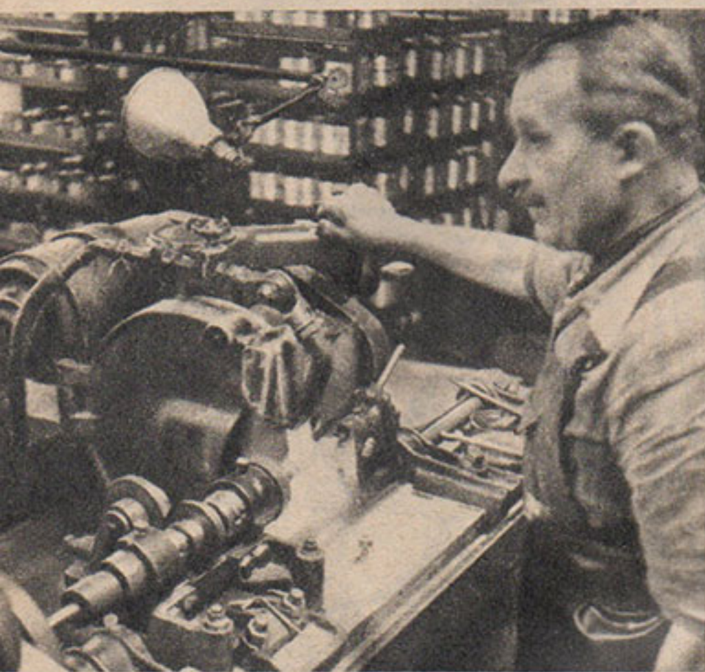
Rectification des cames.
