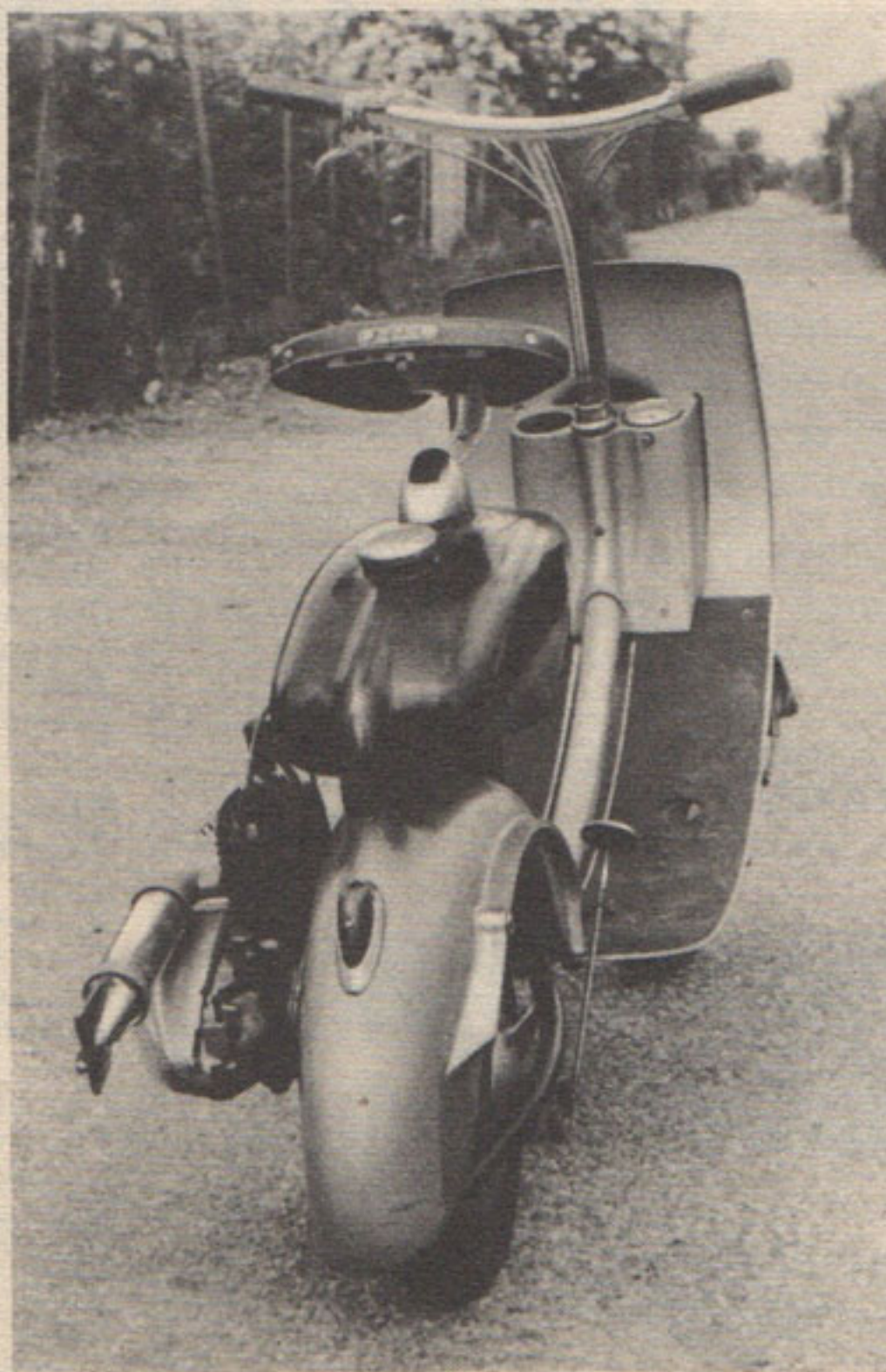
Vue arrière; le moteur est fixé en porte à faux.
