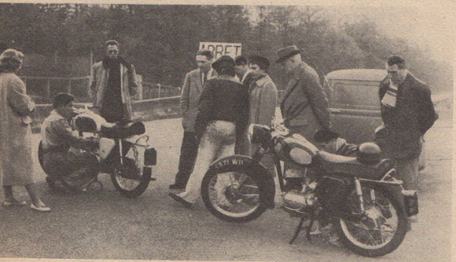
ESSAI DES LIBÉRIA. LE MODÈLE AU PREMIER PLAN EST ÉQUIPÉ D'UN 175 SACHS, ET DES NOUVEAUX FREINS IDÉAL DE DIAMÈTRE 150 M/M. LA MOYENNE OBTENUE SUR LE ROUTIER SE CHIFFRA À 83,805 KM/H (6'34" 2/5).
