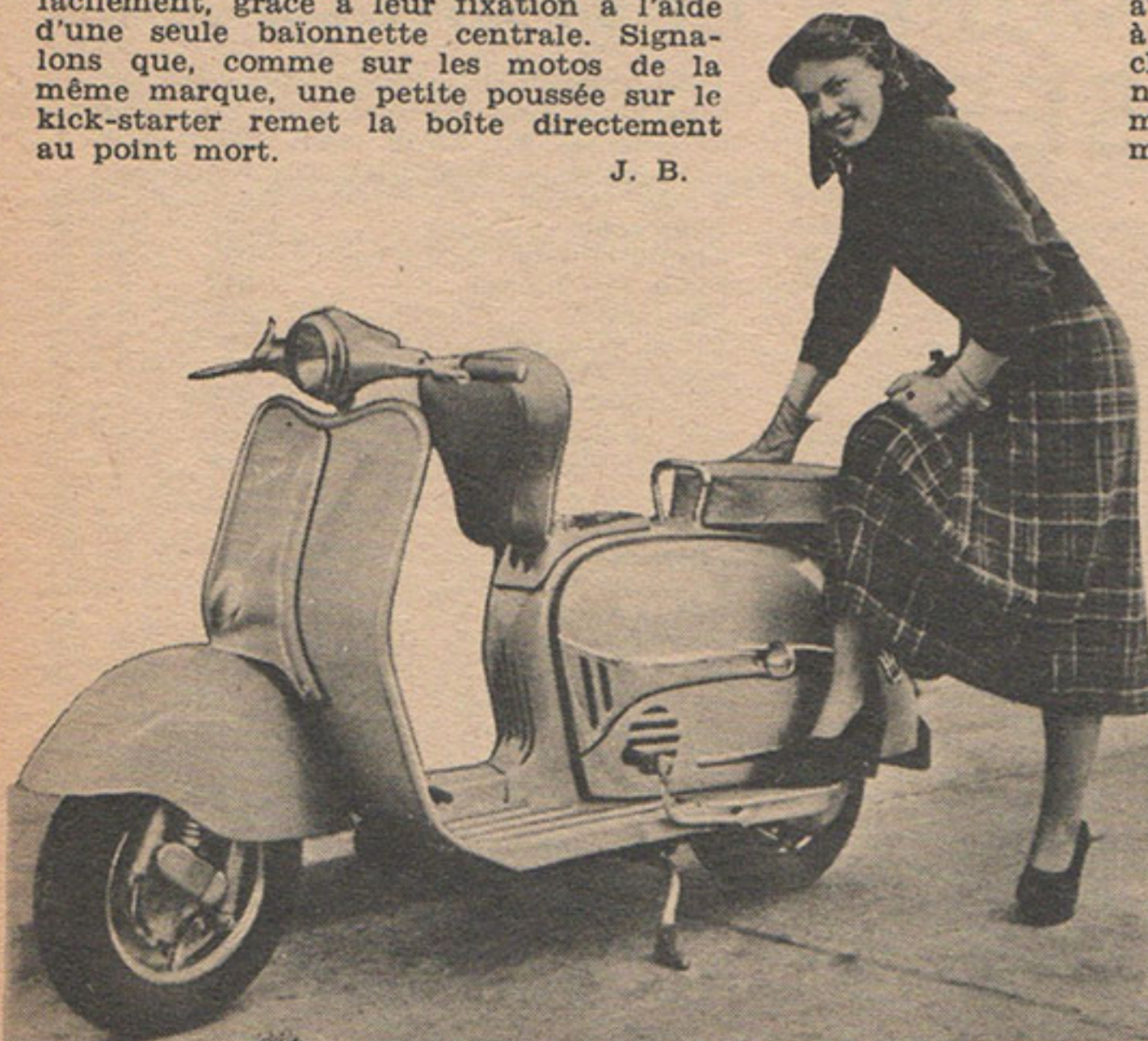
A gauche, le scooter Diana de chez Durkopp est d'une ligne très plaisante. La selle se rabat sur l'avant pour accéder au bouchon de réservoir.
