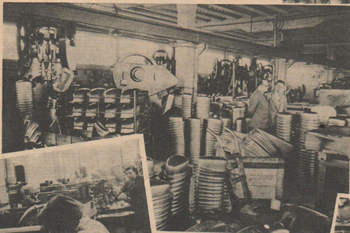
*La soudure électrique est largement utilisée. A gauche, une machine moderne, réglée automatiquement qui donne une qualité de soudure constante. A droite, contrôle d'étanchéité des réservoirs sous pression.*
