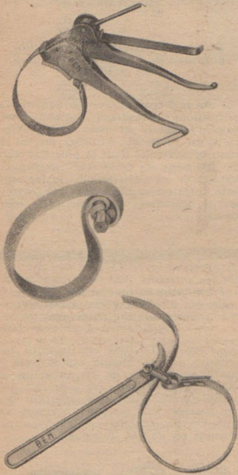
De bas en haut : trois modèles de serre-volants : levier et bande de toile ; bande de cuir ; pince avec bande d'acier.
