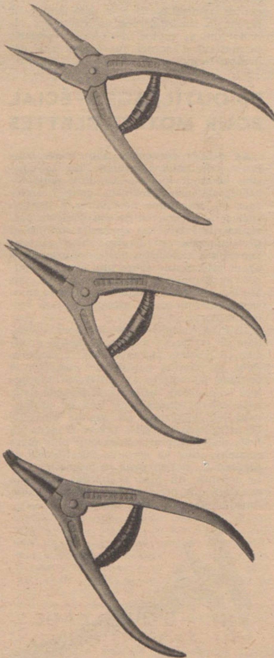
De bas en haut : pince à becs coudés pour circlips extérieur ; pince à becs droits pour circlips extérieur ; pince à becs droits pour circlips intérieur.
