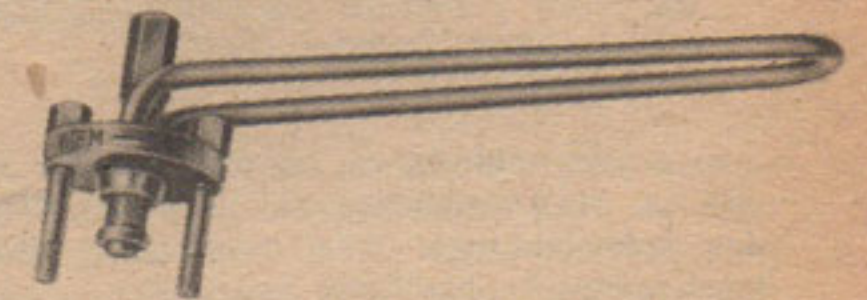
Ci-dessus : extracteur du support de came du volant magnétique Novi.
