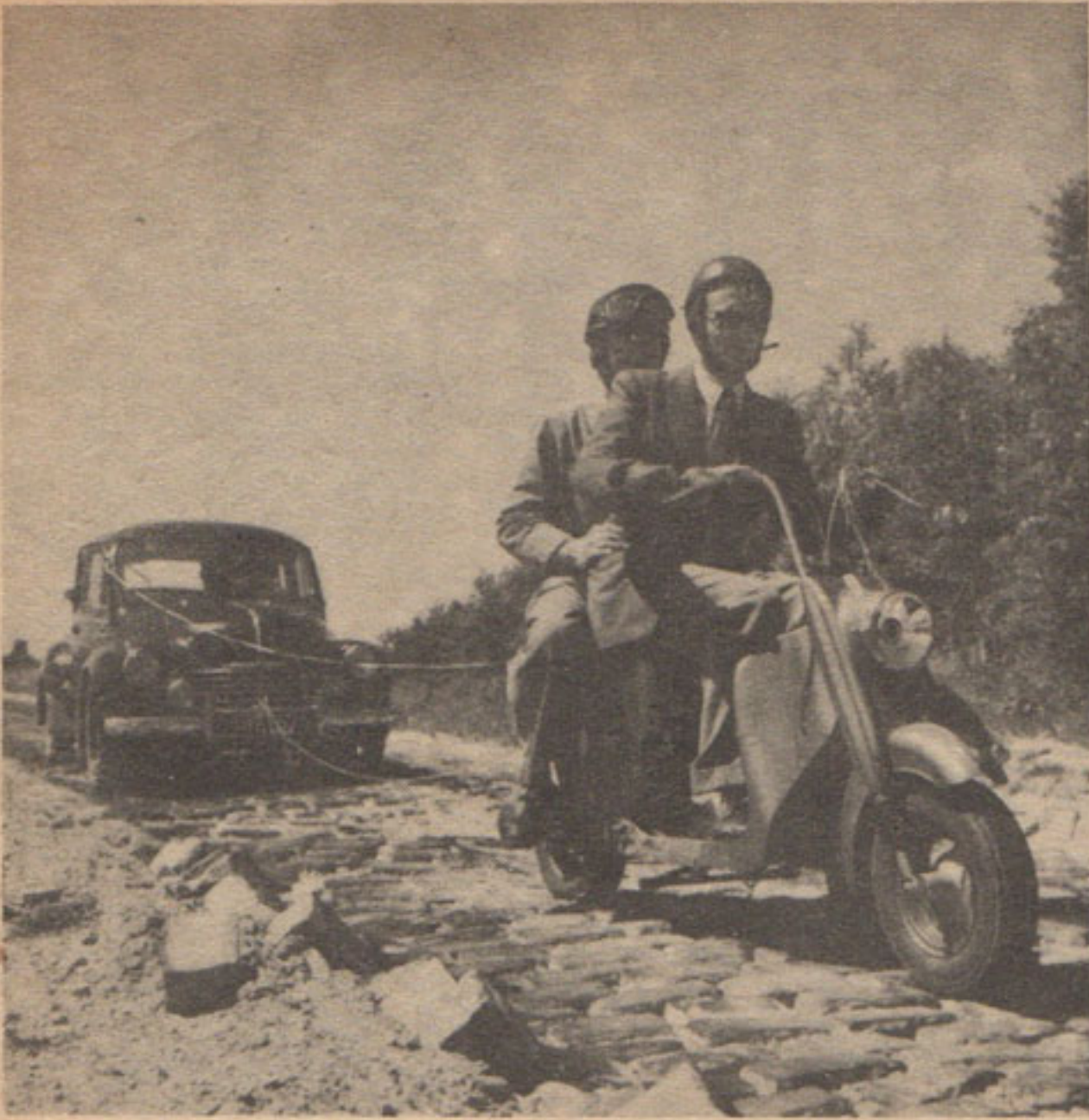
Ci-dessus : étude des contraintes sur un scooter (par Strain-gages) sur le parcours pavé de l'autodrome de Montlhéry. Le véhicule testé est relié électriquement à la voiture suiveuse. A droite : mesure du bruit d'échappement des motos.
