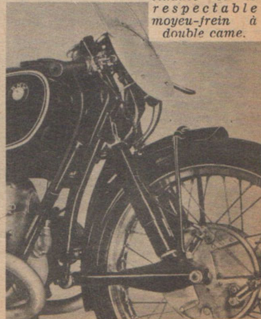
Ci-dessus, à gauche : vue de la suspension arrière et du moyeu-frein d'une « Rennsport » de side. On distingue la canalisation d'huile du frein hydraulique.
