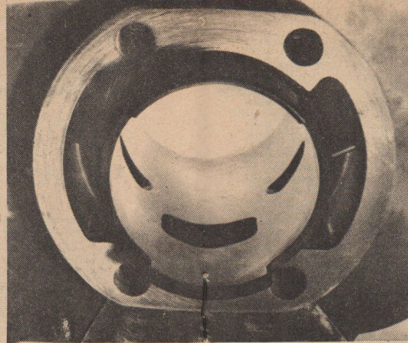
A gauche : les deux entrées dédoublées des transferts, dont le total s'étale sur sensiblement 150°. Deux sorties seulement sont visibles, les deux autres étant cachées par le fût du cylindre. A droite : le moteur démonté, avec le carter en alliage qui vient coiffer la turbine et canaliser l'air sur le cylindre et la culasse (voir également ci-dessous à gauche).
