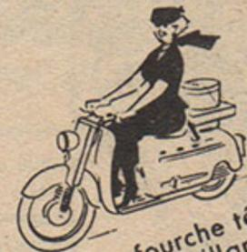
confortable : fourche télescopique à l'avant, bras oscillant à l'arrière, carénage bien étudié
