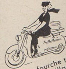
confortable : fourche télescopique à l'avant, bras oscillant à l'arrière, carénage bien étudié
