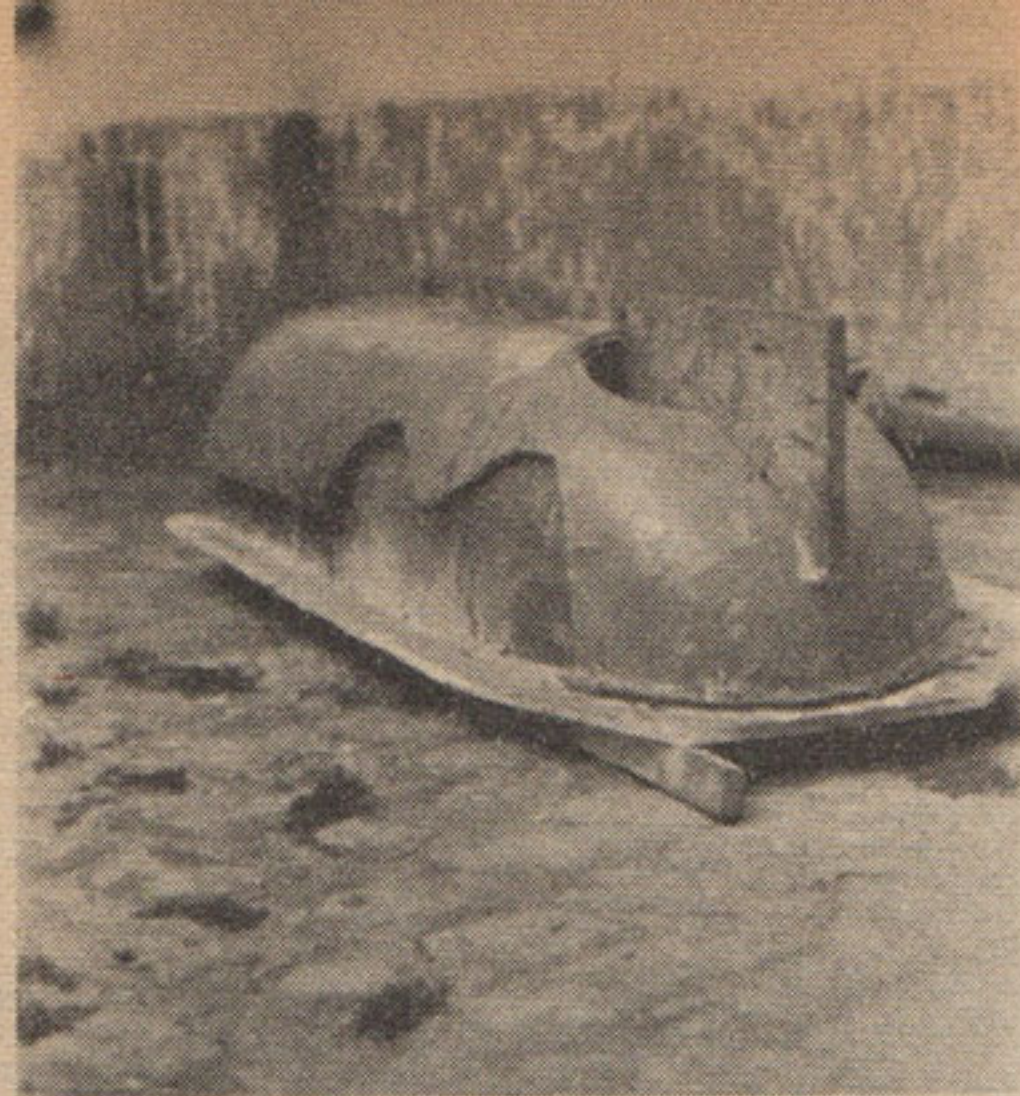
Les diverses phases de la construction du carénage de R. Leconte. - Ci-dessus : la forme femelle en plastique.
