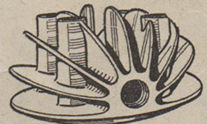
Ci-dessous : Culasse de moteur à deux temps en alliage d'aluminium.
