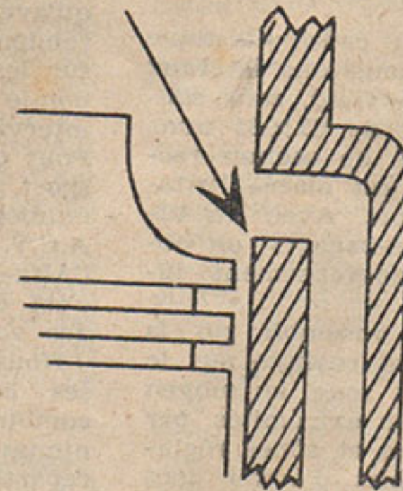
Ci-contre: La flèche montre l'angle vif du canal de transfert qu'il est intéressant d'abattre.
