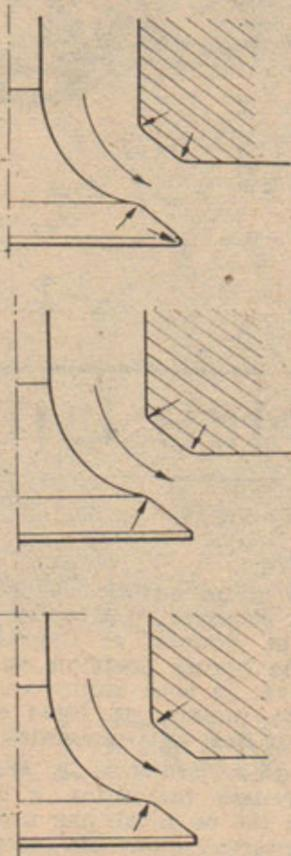
Ci-dessus, les trois combinaisons d'arrondi des arêtes, qui apparaissent les plus favorables à l'admission. A l'échappement (à droite), on a choisi la solution la plus favorable et la plus simple, mais on a fait varier le rayon de l'arrondi.
