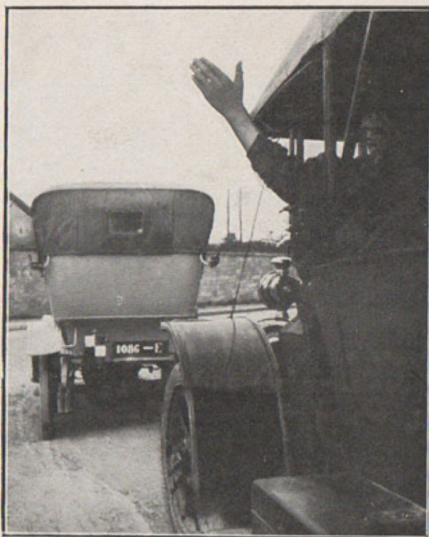
L'ŒUVRE DE L'AUTOMATIC-PROTECTOR LA PREMIÈRE VOITURE, MUNIE DE L'AUTOMATIC- PROTECTOR, SIGNALANT SON RALENTISSEMENT
