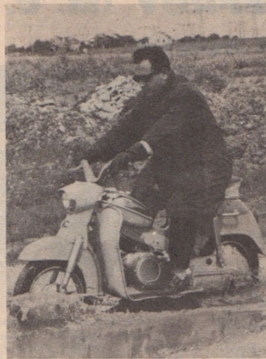
Afin de vérifier la protection efficace du tablier et du plancher nous avons effectué des passages à gué. Remarquons qu'en effet le conducteur n'aura pas (après l'expérience) à astiquer ses chaussures.
