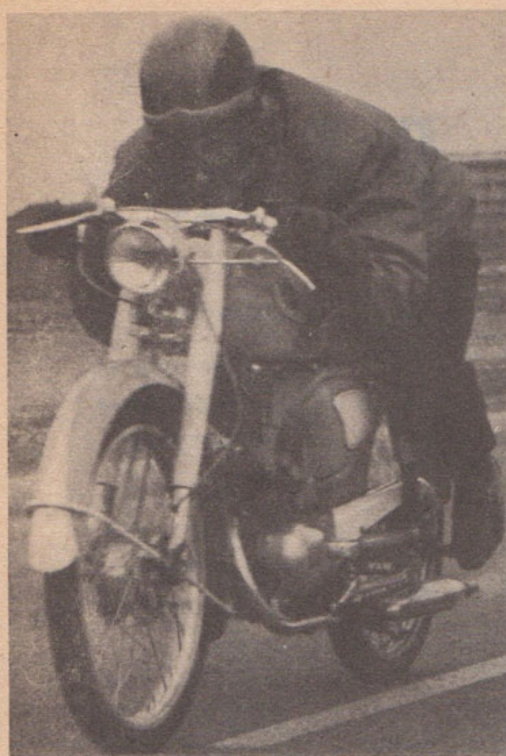
Le ROYAL NORD 4 vitesses pendant les essais de vitesse maximum. Pour plus de facilité, les importateurs avaient monté des repose-pieds arrière (sur l'axe de roue) qui permettent soit la position effacée ou encore le duo... à l'aise.
