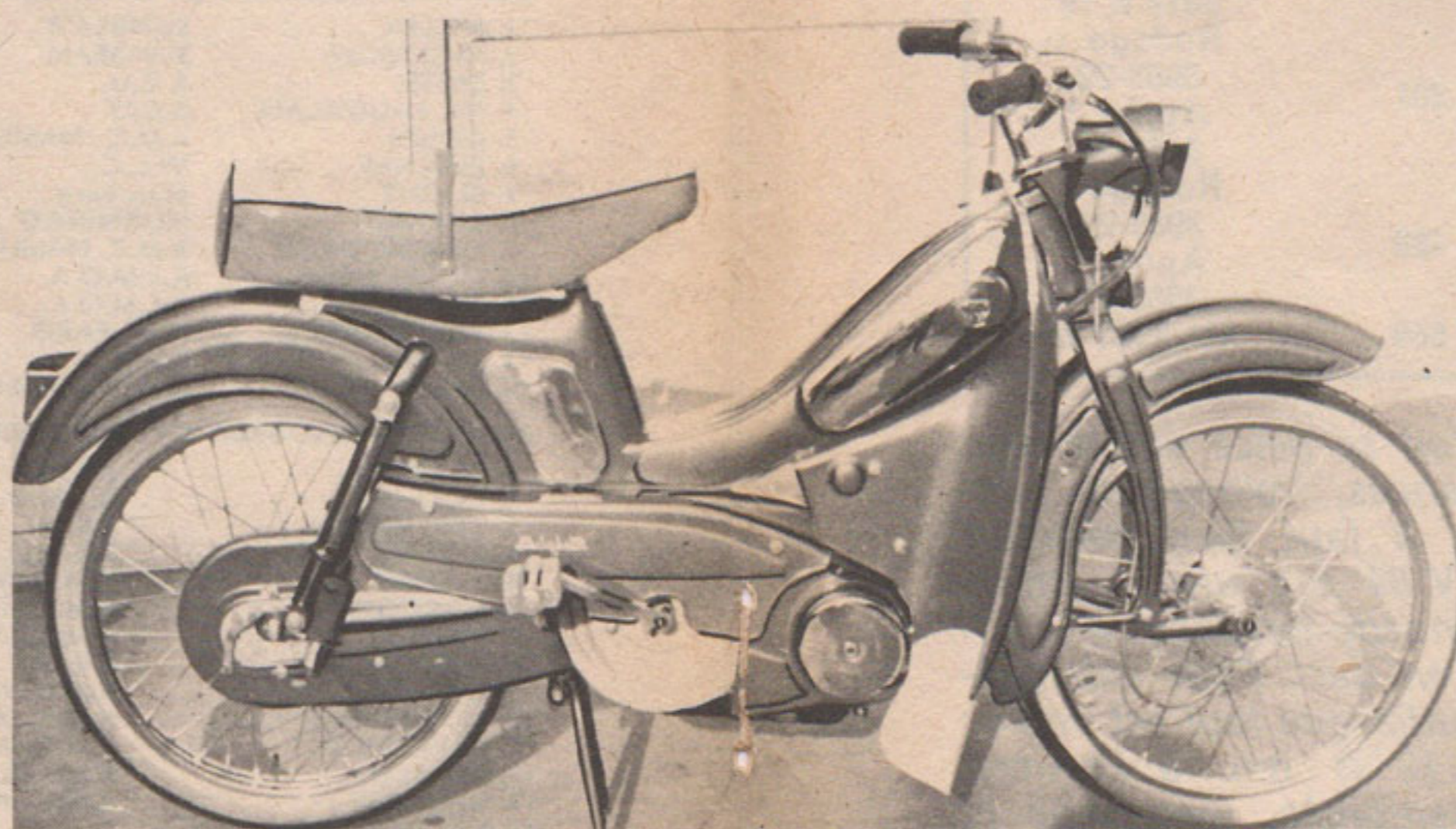
Côté transmission auxiliaire l'on remarque le ressort en épingle du variateur automatique.
