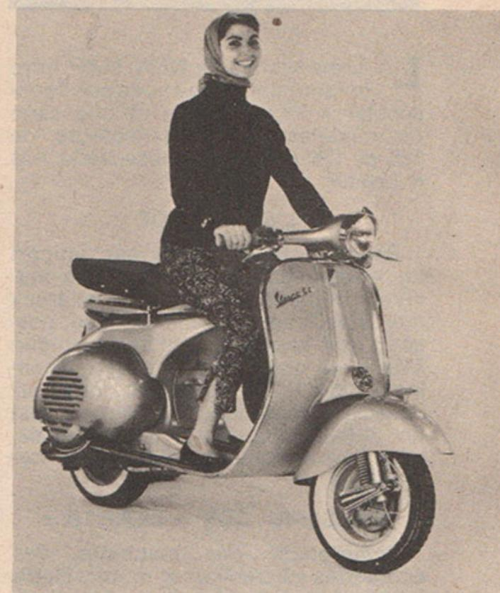
**Moteur :** deux temps monocylindre, culasse en alliage léger. La cylindrée est de 124,8 cm<sup>3</sup> (alésage 56,6, course 49,8).
