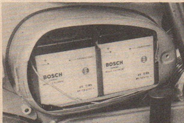
**Sur la SGA la présence du démarreur électrique a rendu nécessaire le montage de deux batteries qui trouvent place dans un coffre « à la cote ».**
