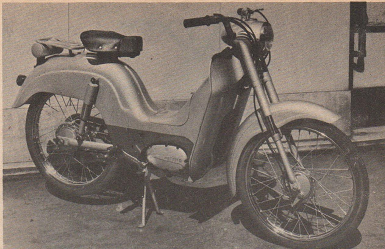
*Le cyclomoteur Alpi qui figure ci-dessus est une parfaite illustration de ce que doit être un cyclomoteur de tourisme où l'on recherche principalement confort et protection. Le cadre coque est très enveloppant et la présence du tablier incorporé procure une protection efficace sans nuire à l'esthétique de l'ensemble qui est très réussie. La fourche avant télescopique et la suspension arrière oscillante se sont imposées. La présentation de l'ensemble est très soignée.*
