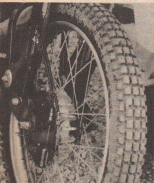
*Fourche et frein avant de la Greeves : les ailettes radiales que l'on voit sur le tambour ont prouvé leur efficacité aux « basses » vitesses. Les bras de la fourche sont montés sur silent-blocs, les amortisseurs sont logés dans les tubes de fourche.*
