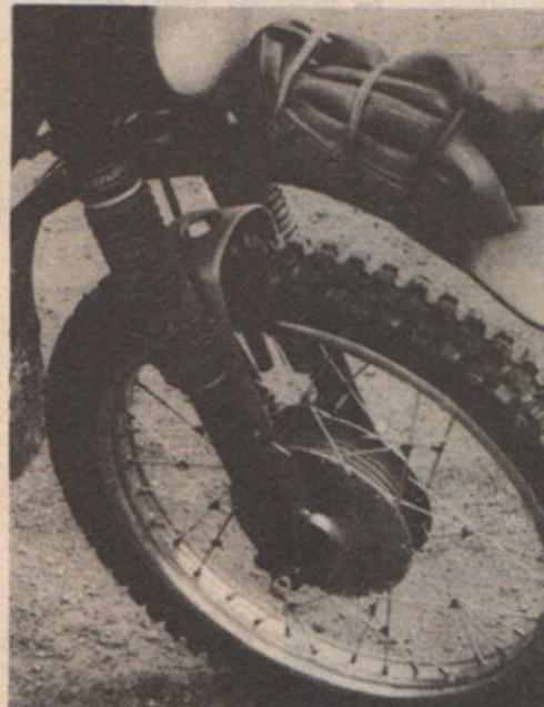
Gilera 250. Notez l'étrier de raidissement monté sur la fourche télescopique. La chambre à air de secours occupe une position pour le moins inattendue.
