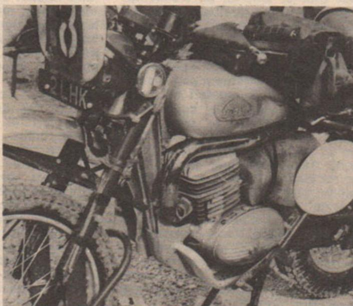
*La 250 Greeves : cadre-poutre en alliage léger embouti de profil I. Le moteur Villiers est équipé d'un cylindre spécial signé Mahle.*
