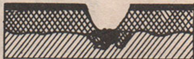
⑤ Métal phosphaté recouvert de sa peinture. la tôle ne s'oxyde de nouveau que là où elle est mise à nue.
