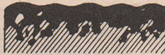
② Métal rouillé après brossage à la carde
