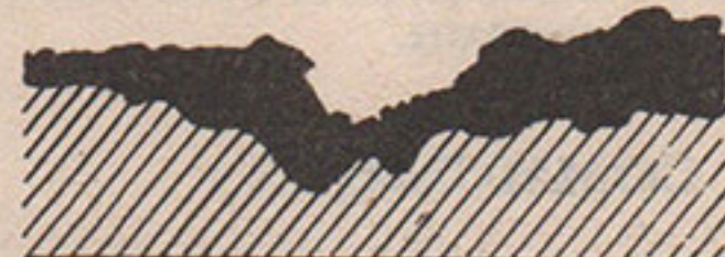
⑥ Tôle peinte sans phosphatation. A la suite d'un choc, la rouille chemine sous le vernis et le craquèle
