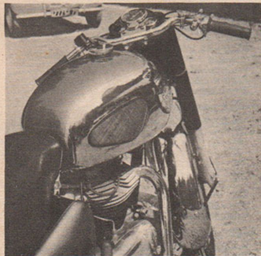
Le tableau de bord de notre machine ; le guidon de série a été retourné sur ce modèle. Le réservoir est du style « Constellation ».
