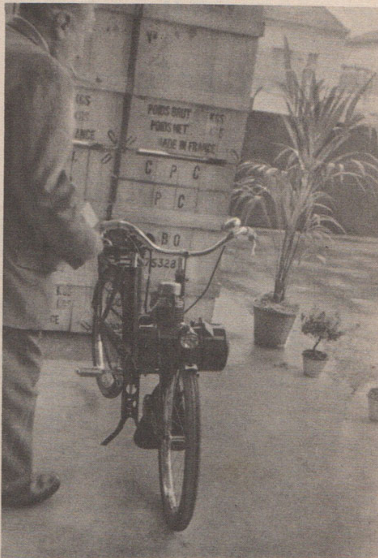
Le nouveau Velosolex « 1700 » : la partie cycle ne subit pas de modifications. Remarquons la sortie de l'air soufflé, au-dessus du carter de droite.
