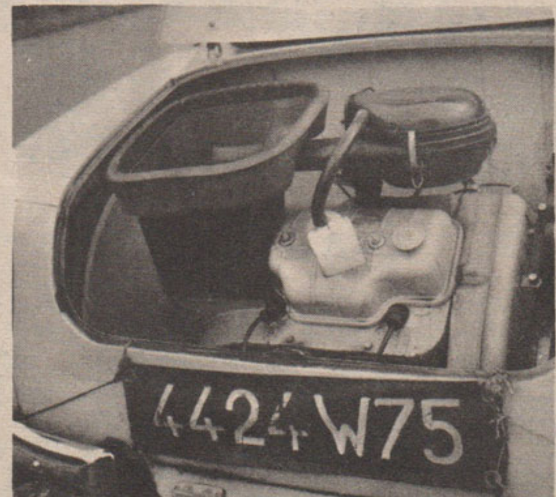
La netteté d'aspect du moteur est assez rare pour être soulignée sans que l'accessibilité aux organes courants, bougies, gicleurs, etc. soit sacrifiée.
