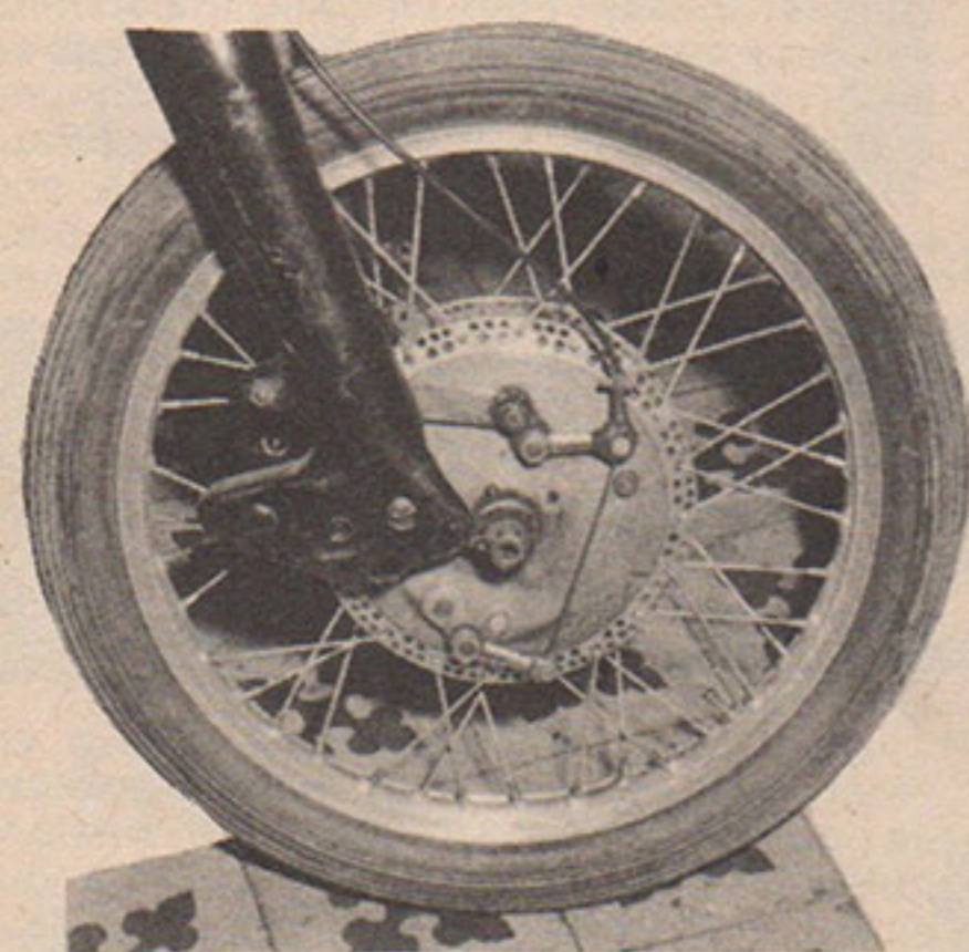
Le frein d'origine a fait place à un double-cames B.M.W.
