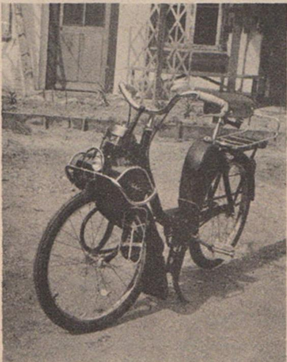
Un pare-chocs tubulaire efficace en cas de chute, se monte aussi bien sur le modèle 1400 que sur le 1700 grâce à deux ferrures spécialement étudiées.
