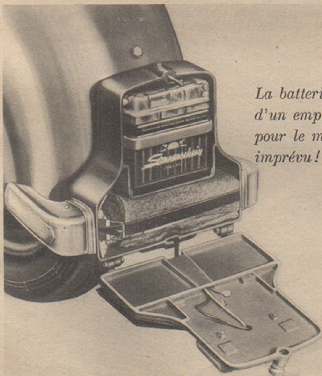
Le changement de bougie est facile grâce à une trappe à ouverture rapide.
