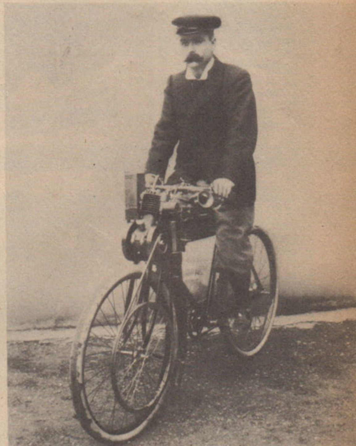
La première machine appelée "Motocyclette". — Elle fut exposée en 1897 au Salon du Cycle à Paris par ses inventeurs, les frères Werner. Le moteur pesait avec ses accessoires 14 kilos. Il était placé sur une bicyclette ordinaire dont la fourche, qui le supportait, avait simplement été renforcée.
