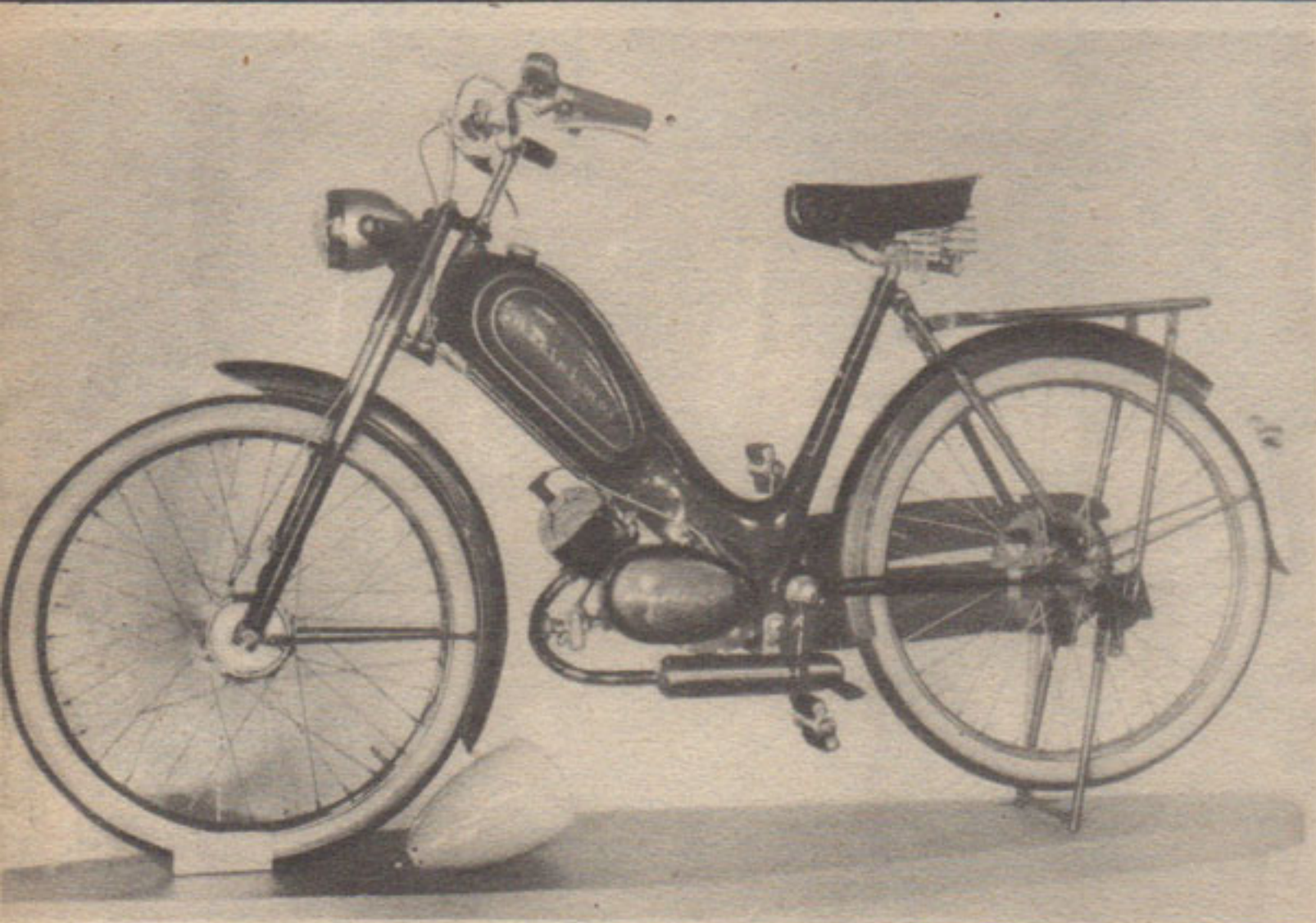
Le cyclomoteur Berini et son moteur deux-temps à distributeur rotatif. Le réservoir fait partie intégrante du cadre.
