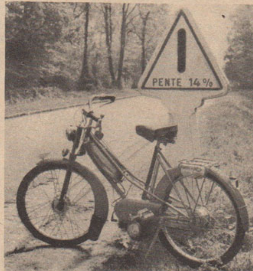
Le Bima au sommet de la côte d'essai. La béquille latérale, montée de série, s'avère très pratique pour les arrêts.
