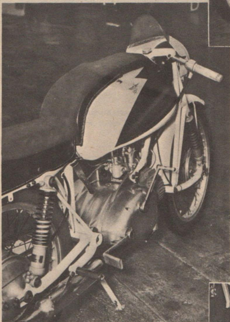
*Le Rumi « Junior » est un 125 cm<sup>3</sup> de sport particulièrement brillant, puisque nous avons pu le chronométrer à 115 km/h sur l'anneau de Montlhéry. Le moteur bicylindre deux temps dispose de cylindres en alu chromés « dur », alimentés par deux carburateurs Del Lorto standard de 18 mm de passage, avec cuve unique.*
