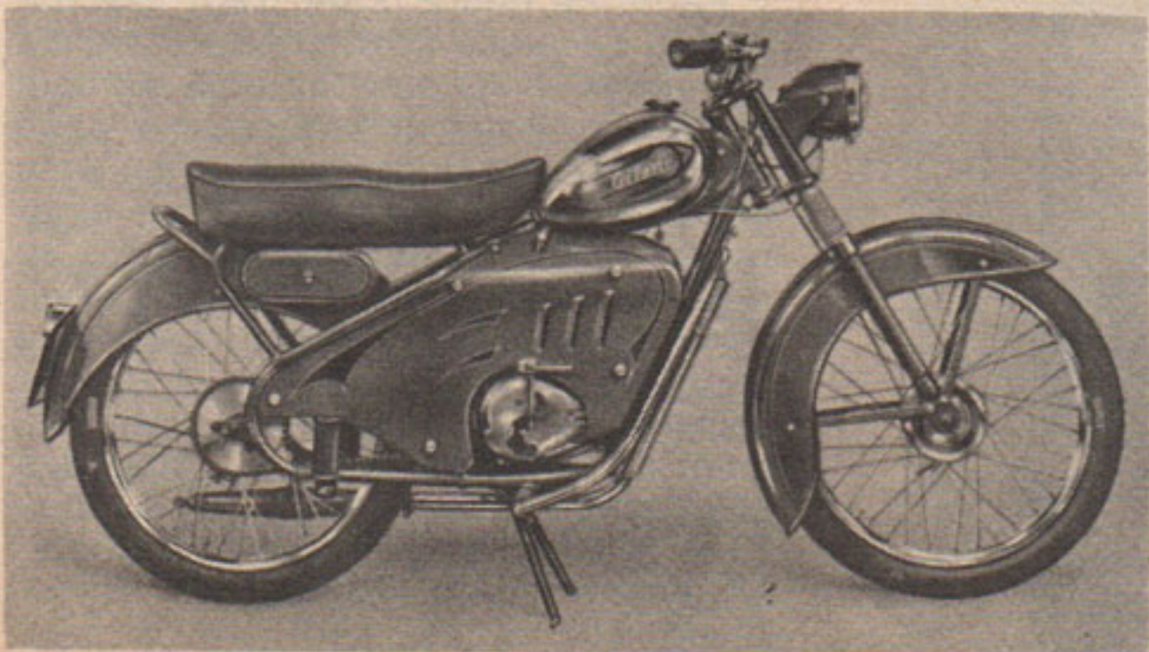
Le vélomoteur Gitane M. 110 utilise le Mistral deux vitesses.
