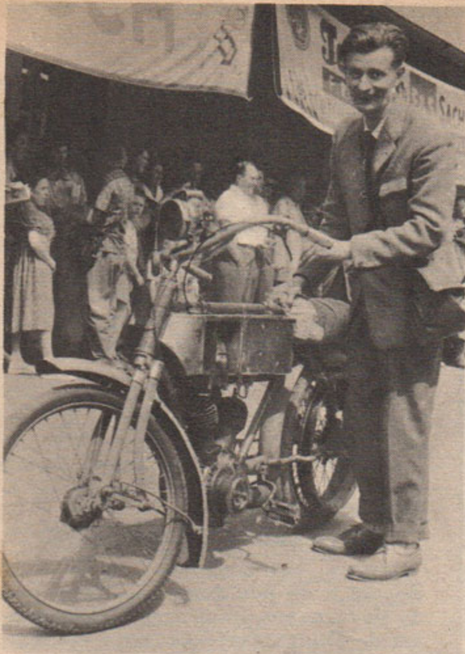
C. Christophe et sa René Gillet de 1903, 527 cm 3 , 4,5 ch. Remarquez la magnéto placée dans le réservoir. et la fourche à roue poussée. La courroie de transmission plate s'est déchirée cinq fois dans la matinée.
