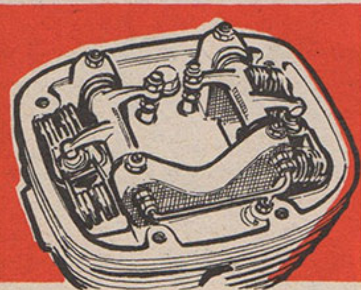
Culasse en alliage léger. Culbuteurs graissés sous pression et entièrement enfermés. Doubles ressorts de soupape en épingle à tension équilibrée.
