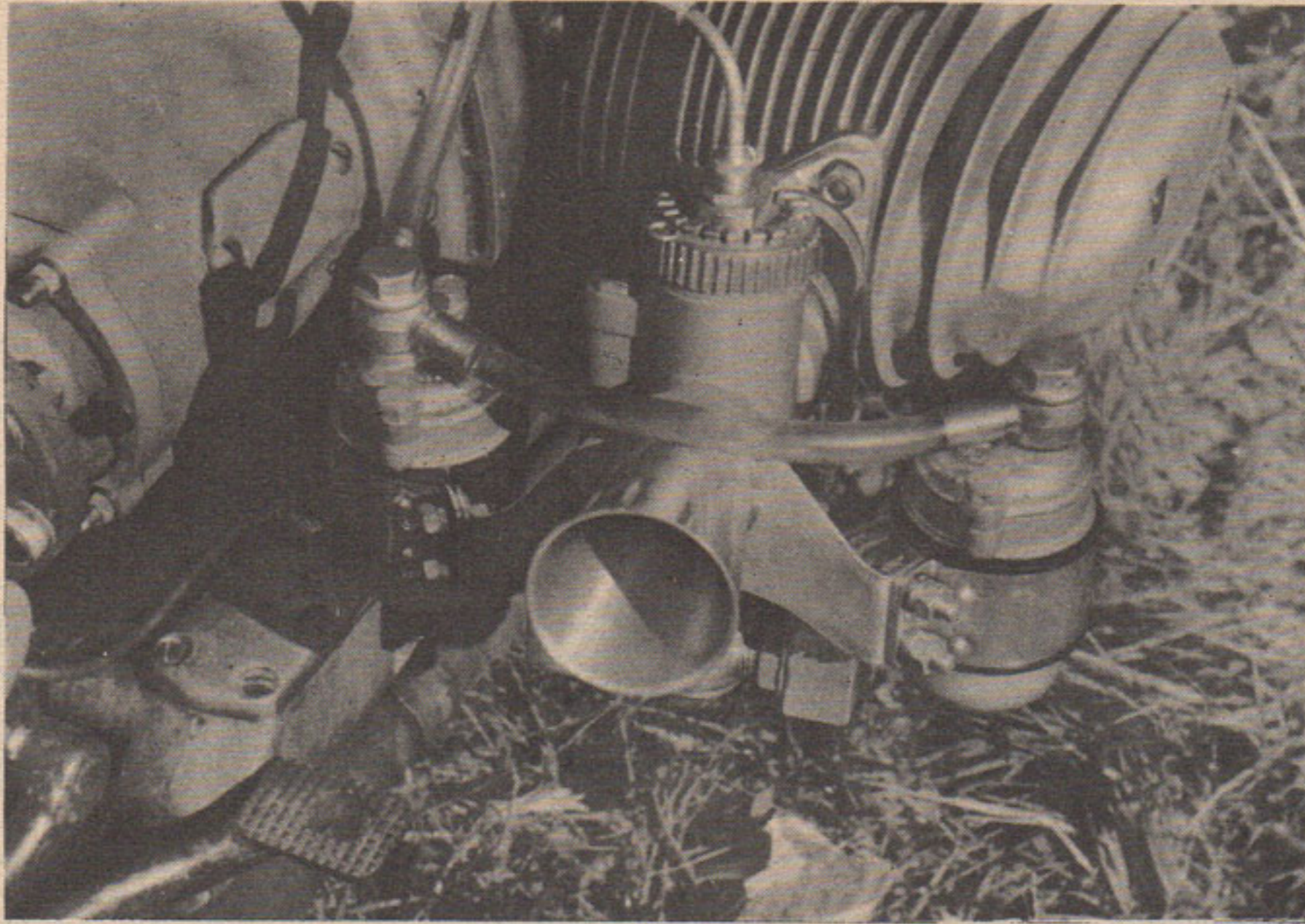
Montage des carburateurs double cuve Del'Lorto sur la machine de Murit.
