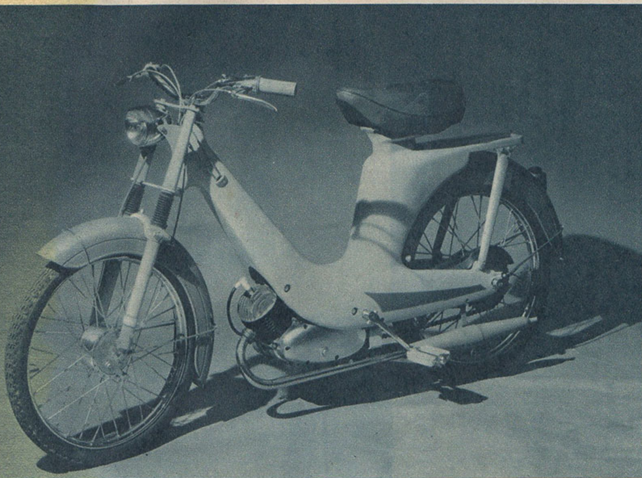
Le nouveau cyclomoteur Automoto utilise un cadre en alliage léger coulé et un 50 cm 3 monovitesse. Les dimensions du bloc laissent prévoir une future version bivitesse.
