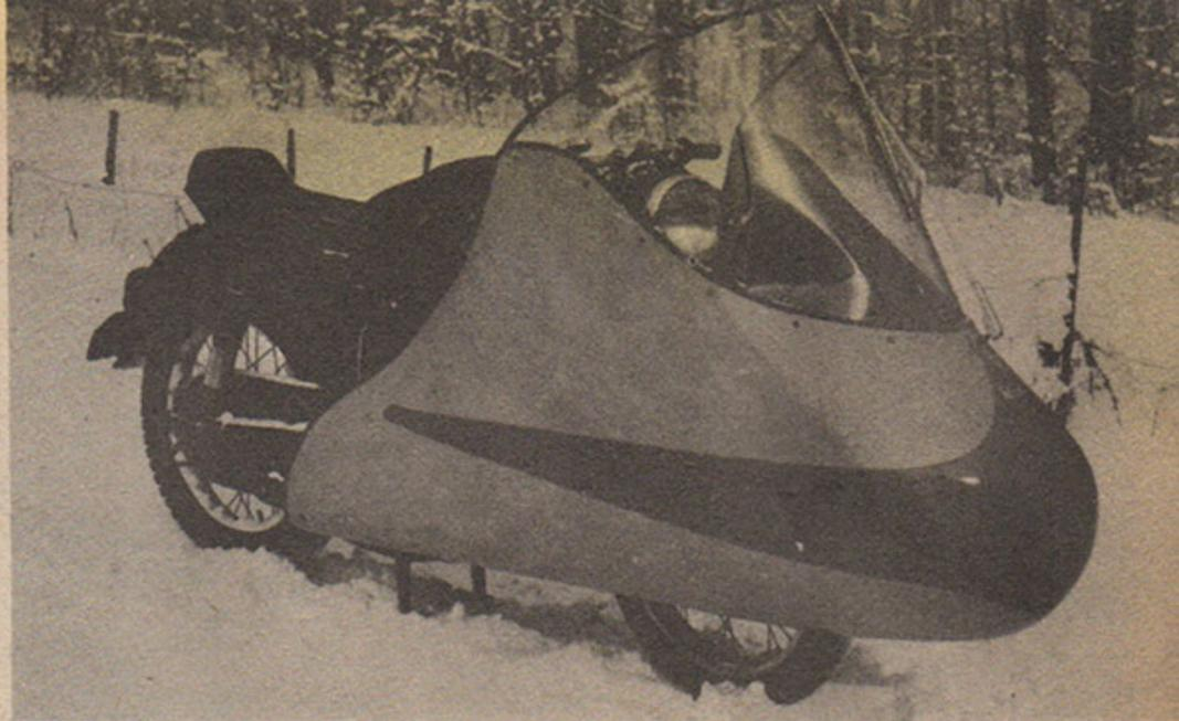
*A notre avis, le pare-brise pourrait être bien plus petit, une sorte de saute-vent en somme. D'autre part il gagnerait à être plus incliné. Cela supprimerait la « cassure » entre le carénage proprement dit et le pare-brise et rendrait superflu l'essuie-glace géant.*
